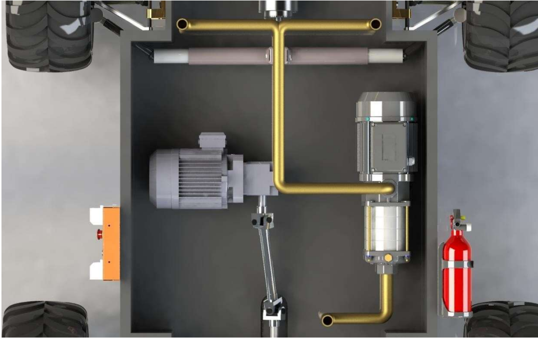
Şekil 4. 77 Yüksek Basıncı Pompa ve Boru Bağlantısı Üstten Görünüşü
