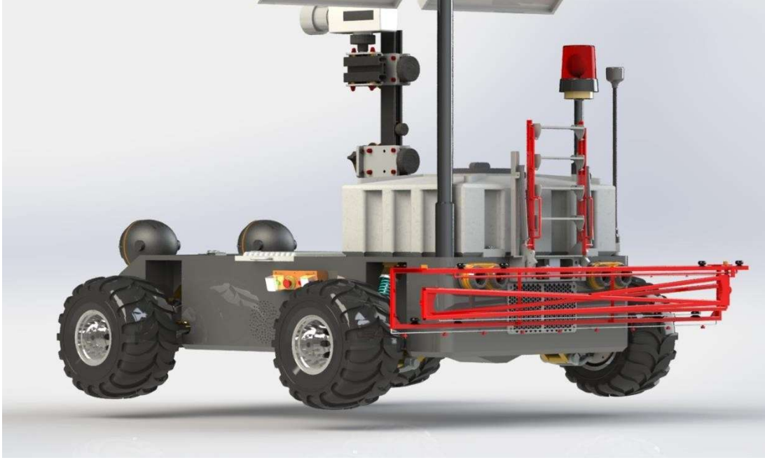
Şekil 4. 90 Yağmurlama Mekanizması Görseli
