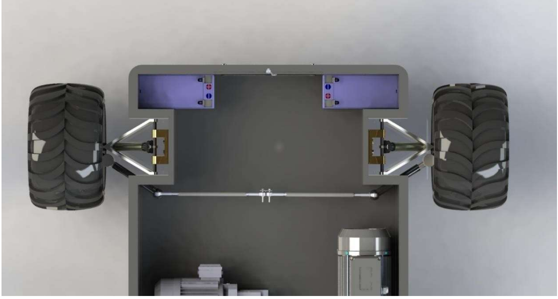
Şekil 4. 30 Ackermann Mekanizması Üstten Görünüşü
