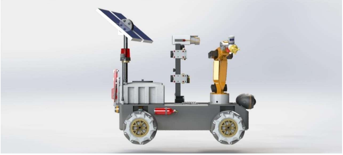
Şekil 4. 19 Omni Tekerlekli Sistemi Yandan Görünüşü
