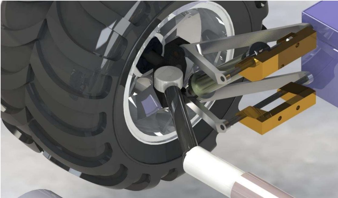
Şekil 4. 35 Rak Pinyon Mekanizmasının Teker ile Bağlantısı
