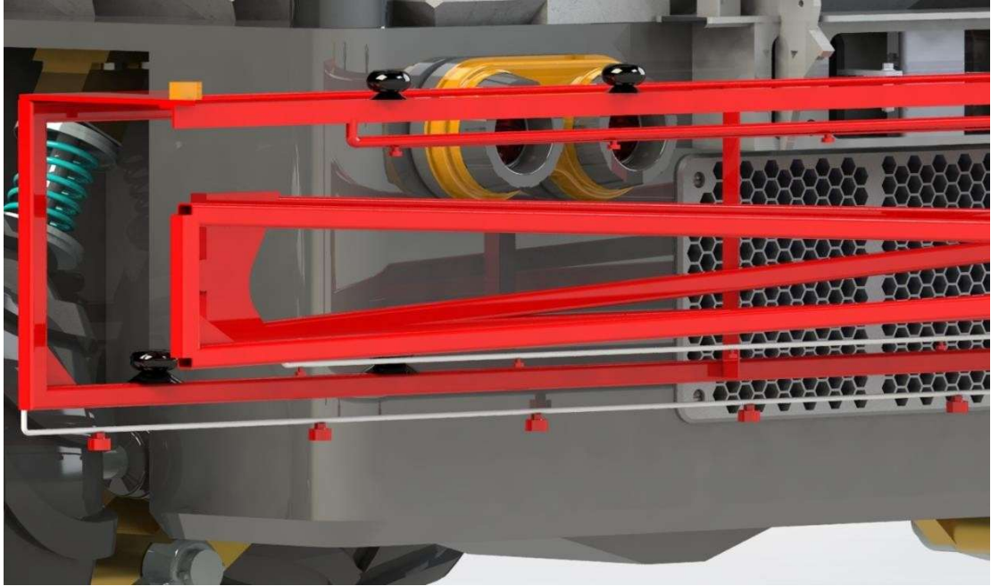
Şekil 4. 91 Yağmurlama Mekanizması Üzerindeki İlaçlama Noktaları Bağlantısı
