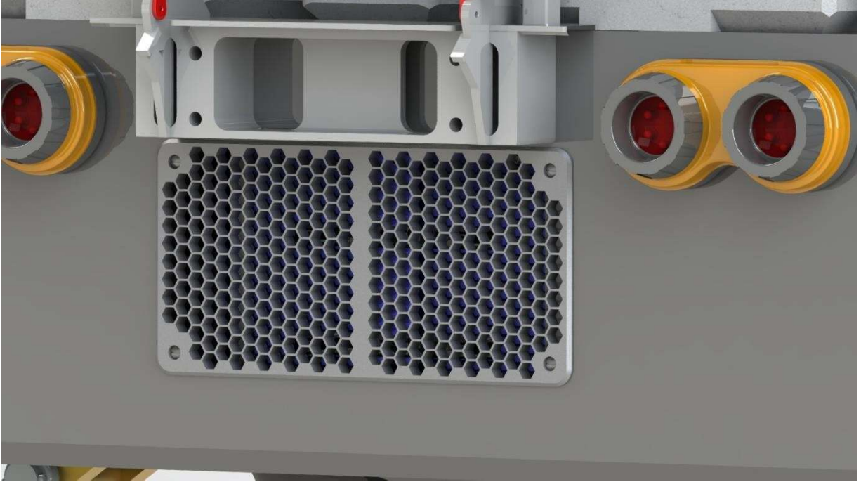
Şekil 4. 130 Arka Kontrol Izgarası
