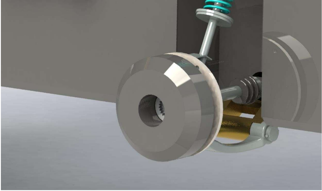
Şekil 4. 41 Elektromanyetik Fren Görseli
