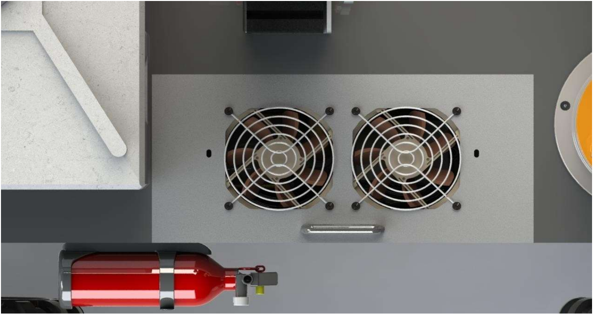
Şekil 4. 137 Pompa Havalandırma Kapağı
