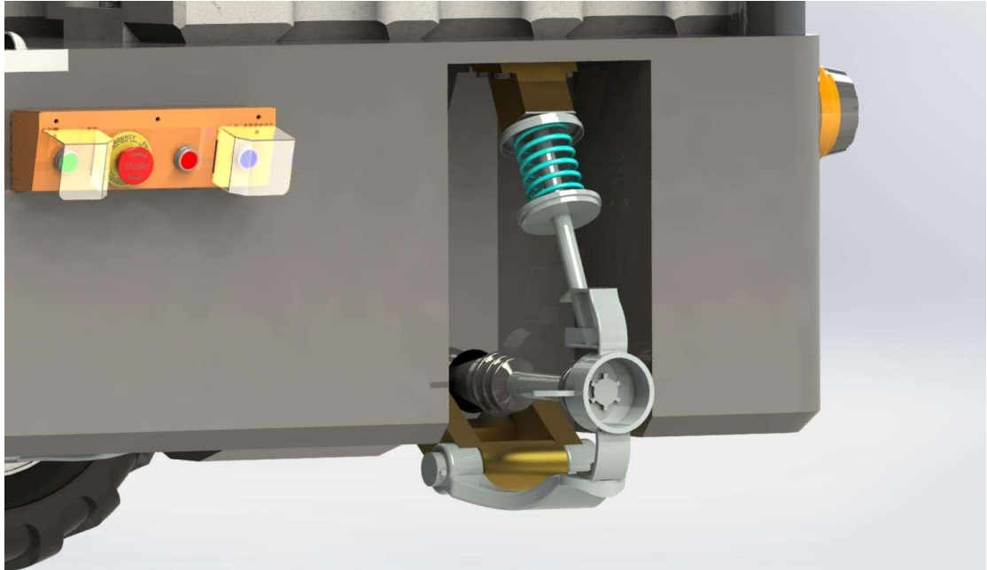
Şekil 4. 60 Arka Amortisör Mekanizma Görseli
