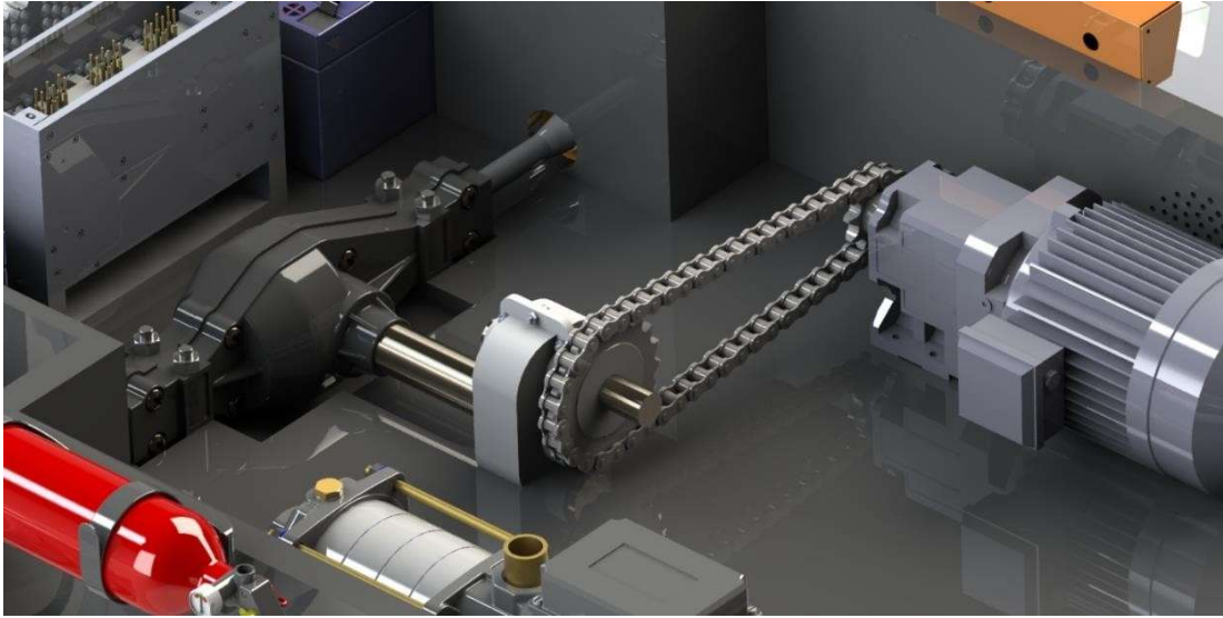
Şekil 4. 14 Zincir Dişli ve Dişli Kutusu Bağlantısı
