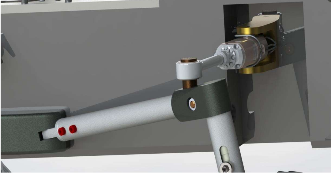
Şekil 4. 51 Hidrolik Tahrikli Açılıp Kapanan Mekanizma Görseli
