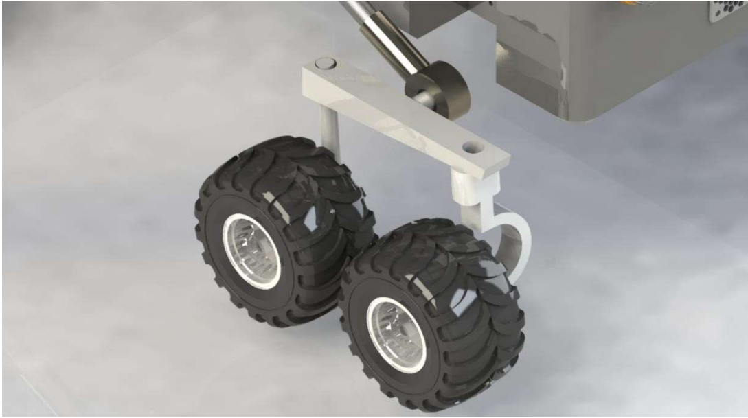
Şekil 4. 54 Teleskopik Mekanizması Arka Tekerler
