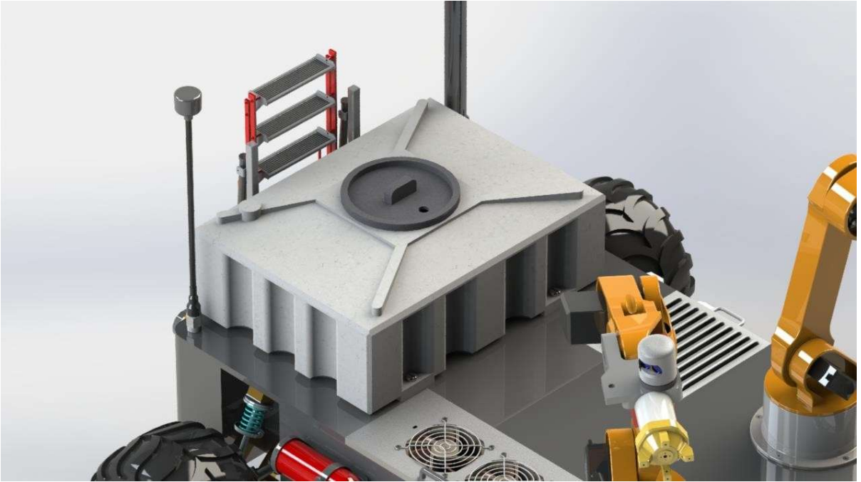
Şekil 4. 111 Lidar Sensörünün Sistem Üzerinde Gösterimi
