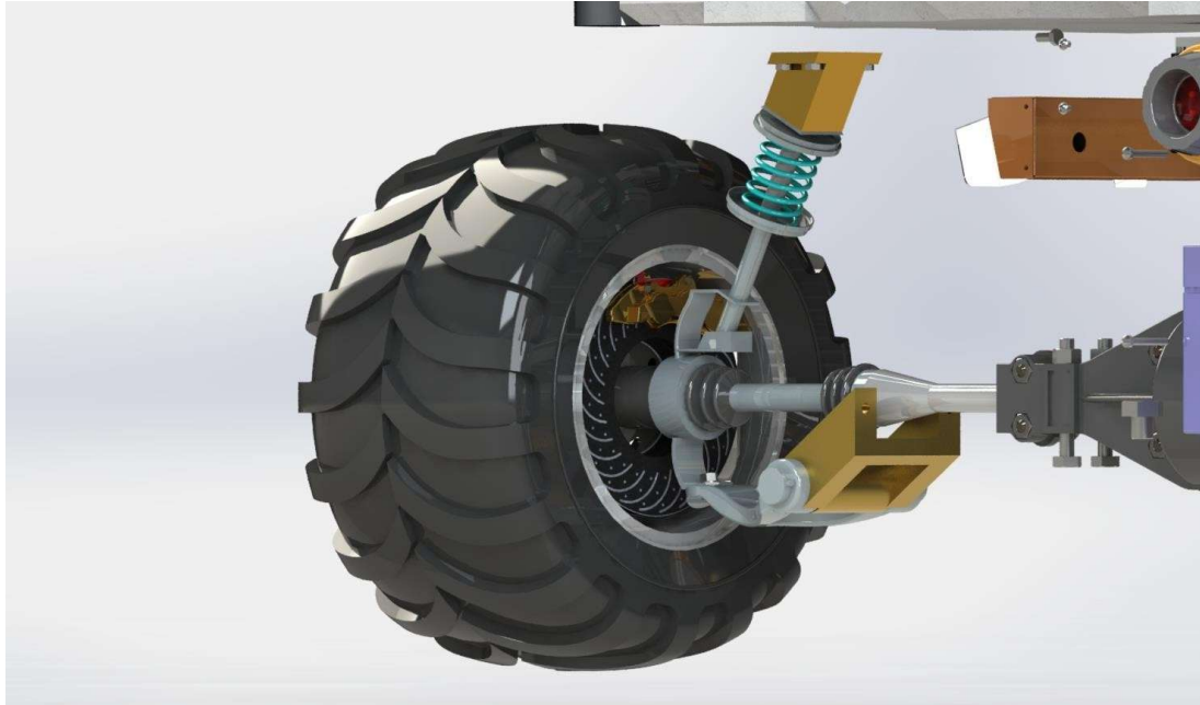
Şekil 4. 45 Disk Fren Bağlantısı görseli
